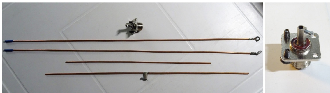
Εικόνα - Η κεραία αποσυναρμολογημένη και λεπτομέρεια από τον κονέκτορα UHF
