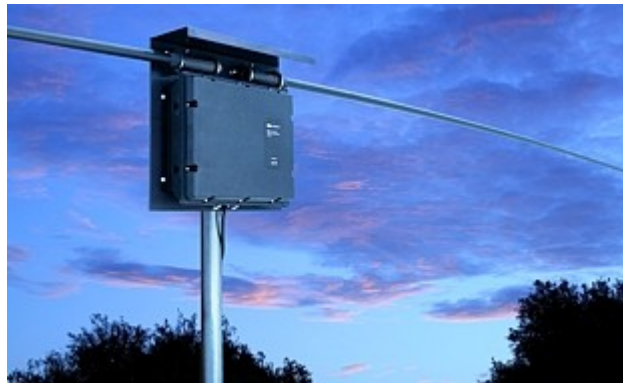
Περιστρεφόμενο δίπολο με antenna tuner. Μία πολύ καλή λύση.
