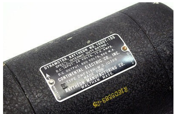
Δυναμογεννήτρια 28V/600V DC/17,5A
