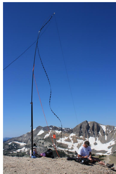
Φωτογραφία 5, είναι τού ND0C στο www.QRZ.com G5RV antenna σε βραχύωδη κορυφή.
