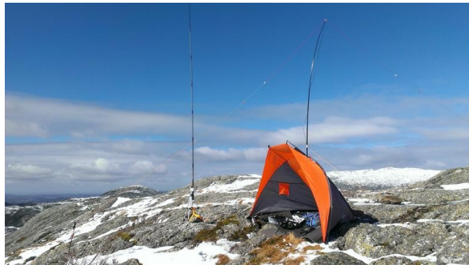
Φωτογραφία 2, είναι του LB8IG στο www.QRZ.com Inverted V και Vertical antenna σε βραχώδη κορυφή.
